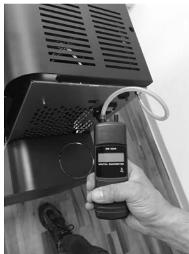
Fig. 48 - Conexión del presostato digital
