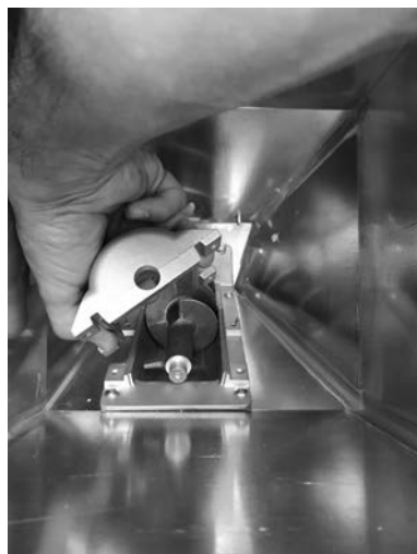
Fig. 50 - Extracción de la cobertura
