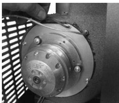
Fig. 54 - Limpieza del aspirador de humos: fase 1
