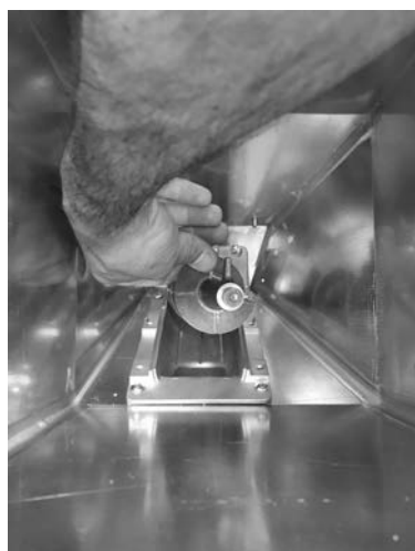
Fig. 52 - Extracción de la espiral
