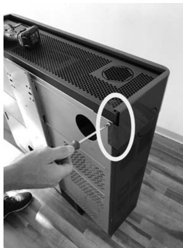
Fig. 35 - Fije los tornillos
