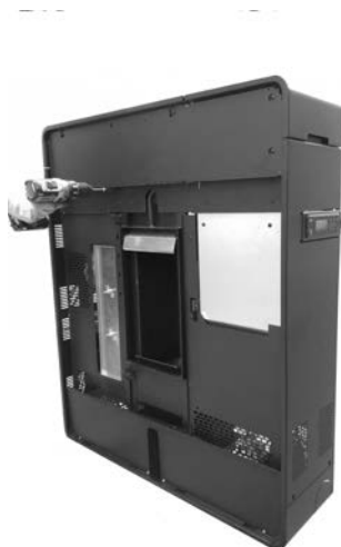
Fig. 36 - Desmontaje abrazadera superior
