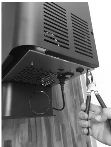
Fig. 47 - Extracción del cárter
